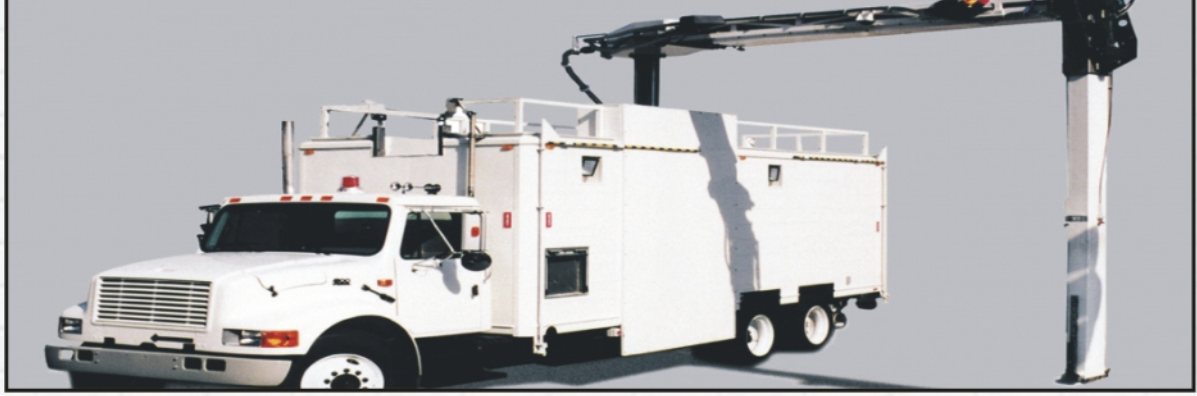
جهاز الكشف المتحرك (موبيل سيرش) للكشف على الحاويات والسيارات ويوجد بسفاجا والدخيلة وبورسعيد ودمياط
